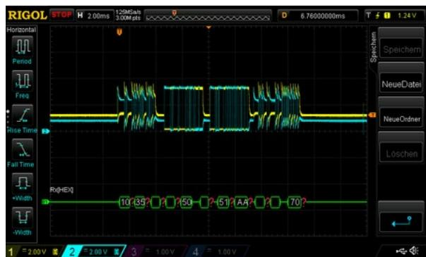
das ausgefranste Signal am Anfang kommt von einem Eingangsmodul, das einen Tastendruck meldet. Diesen Befehl bestätigt sofort das Steuermodul und es schickt auch sofort einen Schaltbefehl an ein Ausgangsmodul. Im Bild sind das die saubereren Signale in der Mitte. Danach sieht man die Bestätigung des Ausgangsmoduls.
